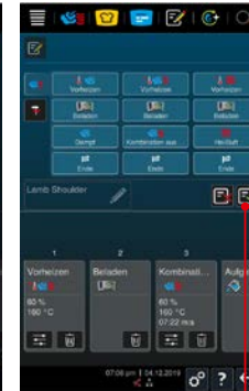
6 Schließen Sie die Programmierung durch Drücken der „Speichern“ Taste ab. Schritte mit fehlerhaften oder fehlenden Eingaben werden beim Speichern angezeigt und können einfach korrigiert werden.
