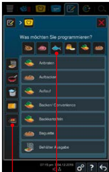
9 Wählen Sie nun den gewünschten Garpfad aus, z.B. „Fisch Grillen“. Mit Hilfe der Filter oben und links ist eine einfache und schnelle Auswahl möglich.
