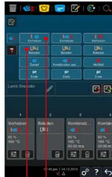
4 Ziehen Sie die Kärtchen für die gewünschten Schritte aus dem oberen Bereich in den unteren Bereich. Sie können zwischen Garschritten und Handlungsanforderungen auswählen.
