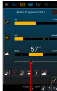
11 Stellen Sie durch Drücken des „Einstellungen Buttons“ die Garparameter ein. Bestätigen Sie die Einstellungen mit dem grünen Haken. Schließen Sie die Programmierung durch Drücken der „Speichern“ Taste ab.
